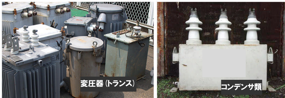
図-5.5.1 PCB 含有電子機器（トランス・コンデンサ類）の例
